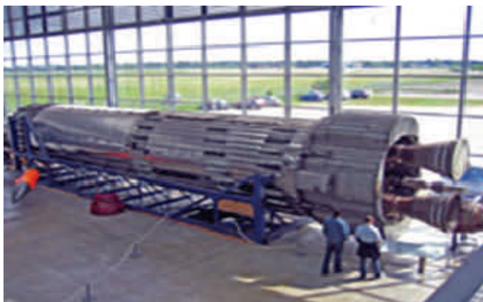
အာကာသဒုံးပျံယာဉ်၏ ကိုယ်တည်အစိတ်အပိုင်းများ၊ လောင်စာလှောင်ကန်များကို စွန်းထင်းခံသံမဏိ ဖြင့် ဖြင့်ပြုလုပ်ကြသည်။ Saturn V rocket
